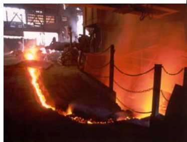
Une coulée de fonte, celle-ci va être moulée dans une machine à couler.
