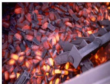
A la sortie de la machine à couler, on obtient le produit fini de l'usine : des gueusets.
